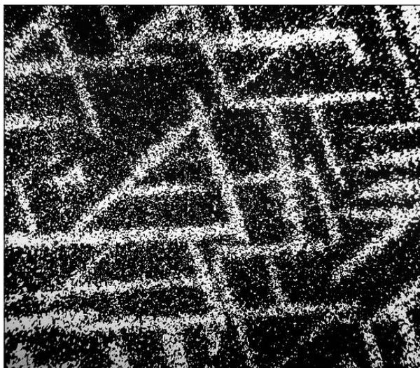
Рис.8. Пластины гематита с 23%  $\text{TiO}_2$  (белое), образовавшиеся в титаномagnetите с равномерным распределением титана (черное) при его прокаливании в окислительной среде при  $1000^\circ\text{C}$  в течение 1 ч. Месторождение Африканда (Кольский п-ов). Аналогично возник и титаногематит СУБРа. Аншлиф, отраженный свет. Увеличение 300.
